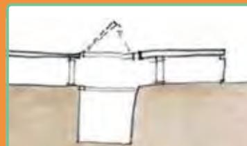
En cas d'implantation sur réseaux: principe d'ouverture pour accès au fil d'eau en bordure de trottoir
